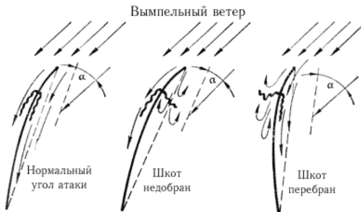
Рис. 23. Поведение индикаторов в зависимости от угла атаки паруса.
