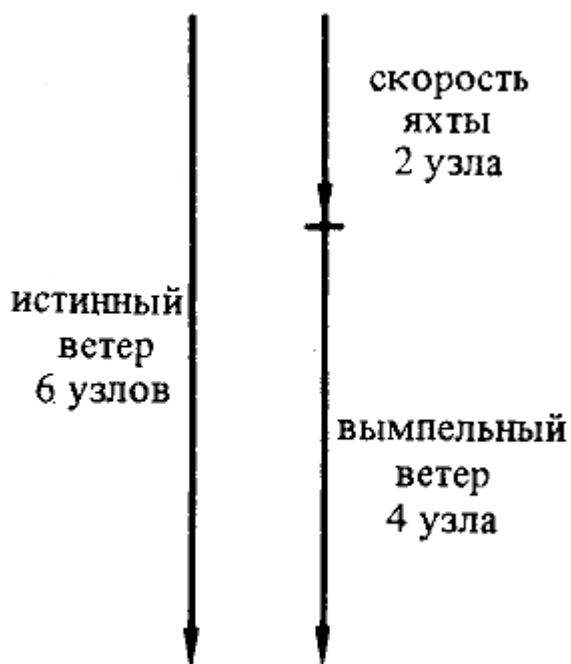
Рис. 12. Движение яхты уменьшает скорость вымпельного ветра.
