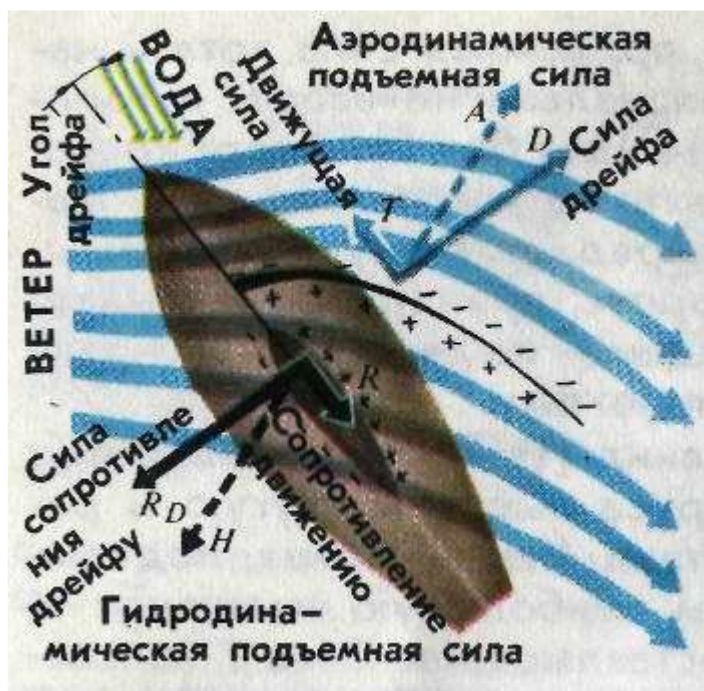
Силы, действующие на корпус и паруса яхты.
