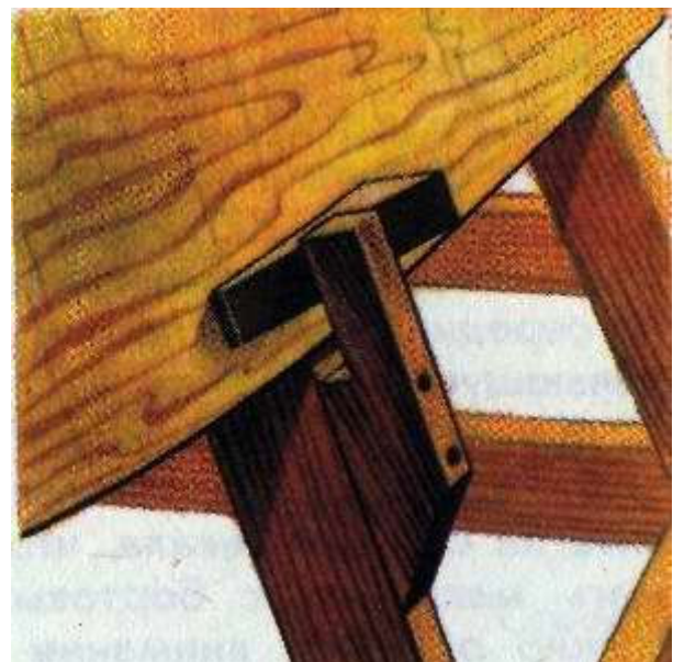
Упоры с клиньями для поджатия бортовой обшивки к лекалам на шп. 3 и 5.
