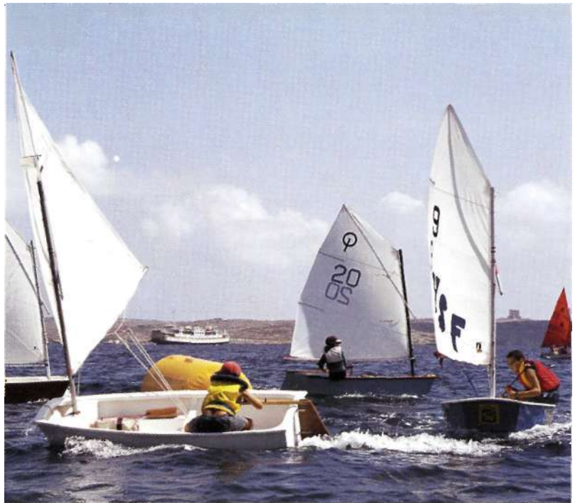
Яхта на заднем плане лавирует с наветренной стороны. Скоро она повернет на другой галс и будет двигаться курсом бакштаг (яхта справа уже идет в этом курсом), а затем легко пойдет при попутном ветре, как лодка впереди
