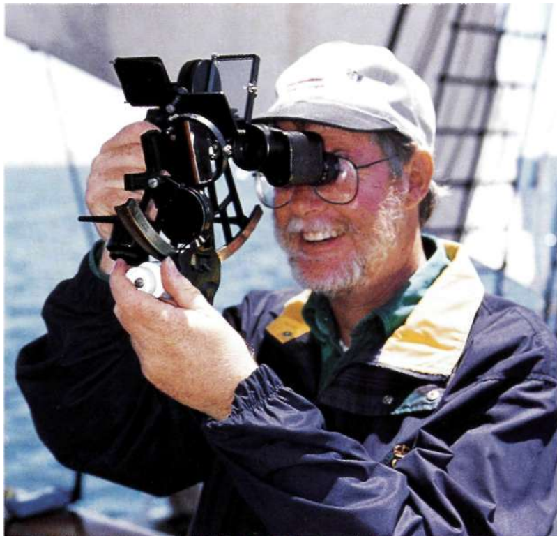
Большинство показаний секстанта снимается по Солнцу, процедура измерений по Луне, планетам или звездам будет идентичной, только светофильтры не понадобятся
