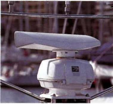
Качество сканера определяет качество изображения на экране радара. Здесь изображен сканер со сложной антенной радара дальнего действия
