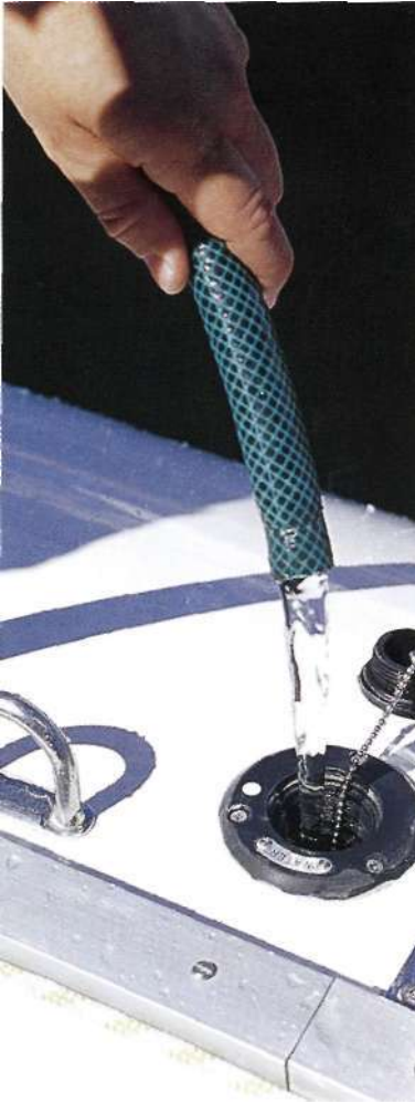
Баки для воды обычно заполняются через отверстие, открывающееся на палубе
