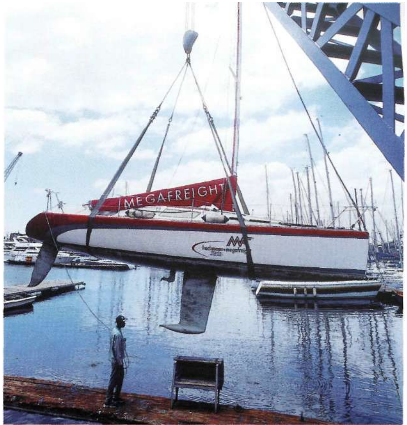
Килевую яхту спускают на ВОАУС ПОМОЩЬЮ крана после ежегодного осмотра и обслуживания
