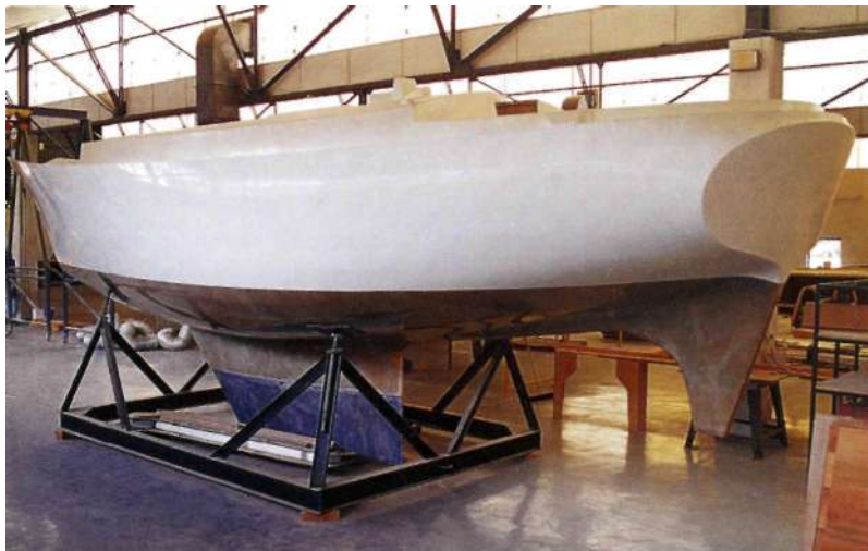
Стеклопластик - самый популярный строительный материал, используемый для промышленной постройки яхт
