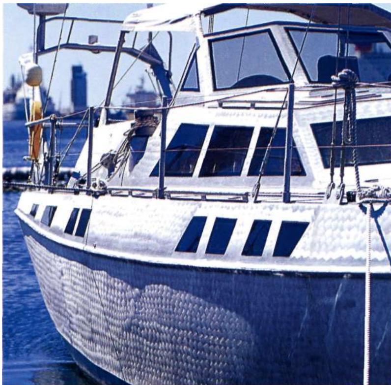
Алюминиевый корпус этой яхты оставлен неокрашенным, чтобы можно было сразу заметить начавшуюся коррозию
