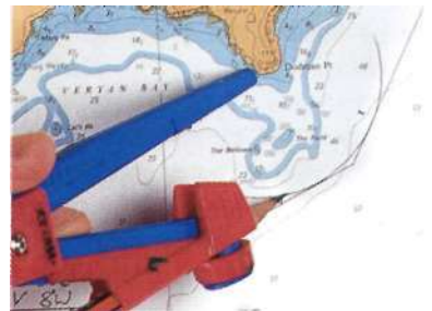
Дуга вычерчивается циркулем, его ножка ставится в самую крайнюю точку опасного места. Яхта не должна двигаться внутри этой дуги
