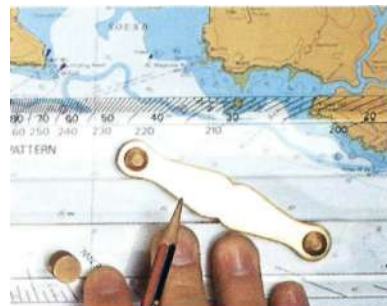
Нанесение местоположения: параллельная линейка размещается по линии широты на карте, а потом перемещается параллельно АО нужного места
