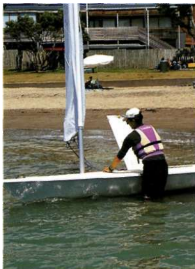
Направьте нос швертбота в сторону моря, доведите его до глубины, достаточной для руля. Шверт опустите в ВОАУ не полностью
