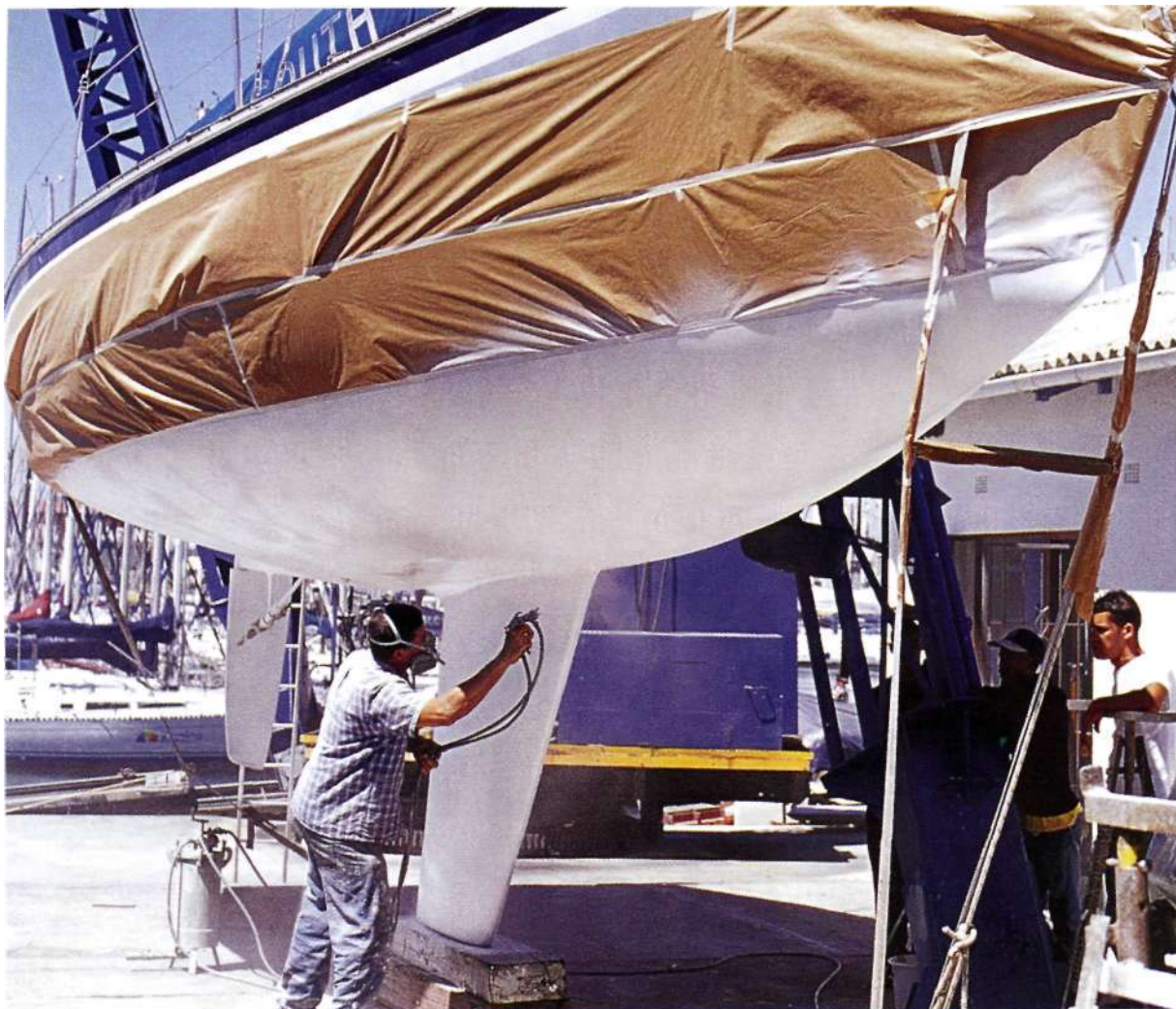
Яхта поднята на стапели для обычного обслуживания. Свежий слой краски наносят на только что очищенный киль
