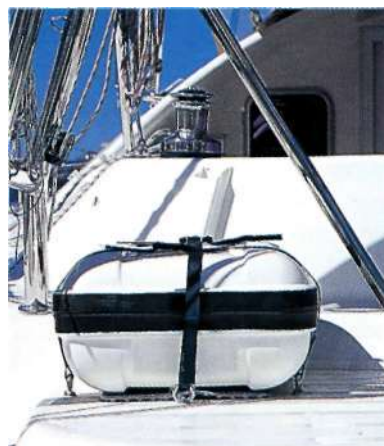
Большие спасательные плоты, такие, как этот, часто хранят на палубе, возле кормы
