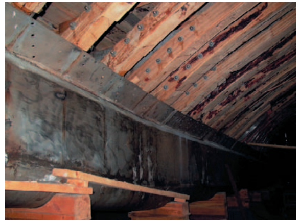
Нержавеющий киль вмещает в себя 65 тонн свинцового балласта и надежно защищает уникальный корпус от касания грунта.
