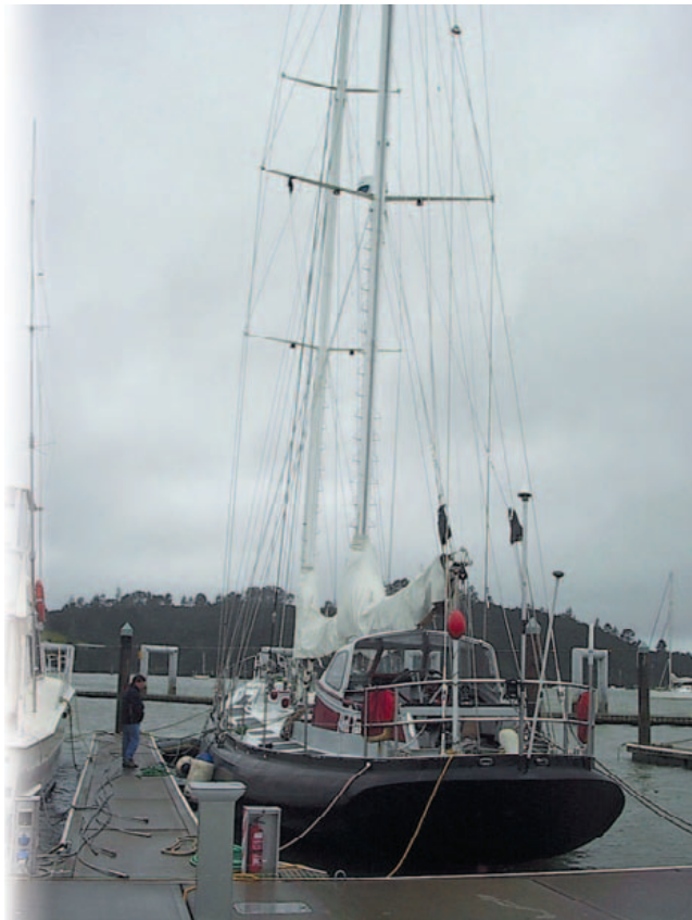
Шхуна подключена к универсальной колонке в марине, от которой одновременно пополняет запас пресной воды и подзаряжает аккумуляторы.
