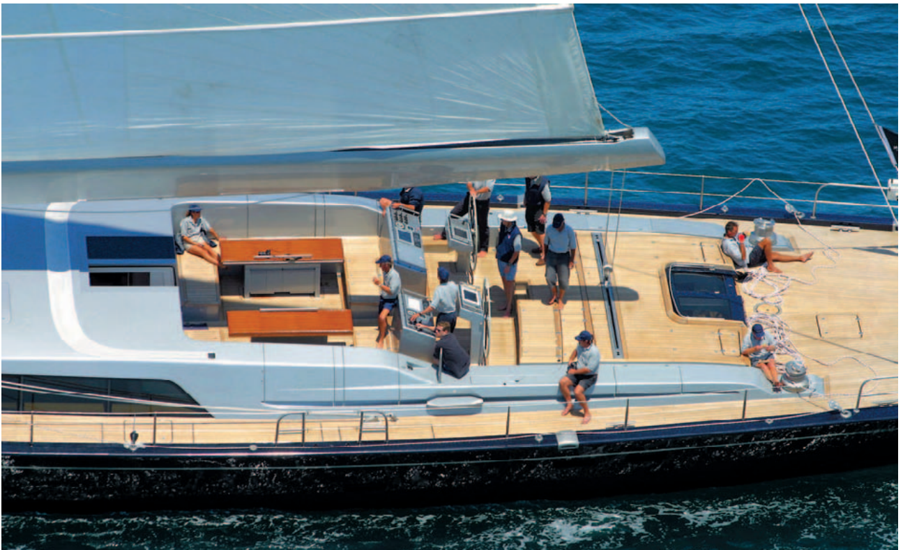
Эта эксклюзивная парусная яхта построена в XXI веке. Тиковая палуба подчеркивает отсутствие многочисленных традиционных деталей оборудования. Яхта управляется экипажем с помощью компьютера. Видна часть углепластикового гика и кевларового грота.
