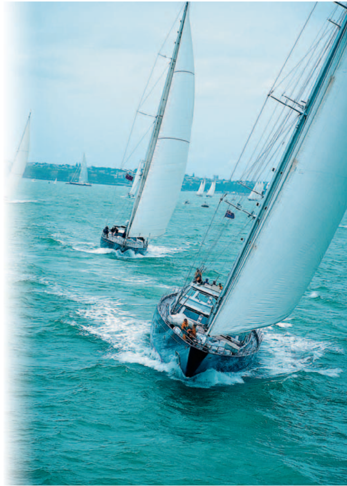
Тяга парусов обеспечивает движение яхты против ветра и создает крен и дрейф в подветренную сторону.
