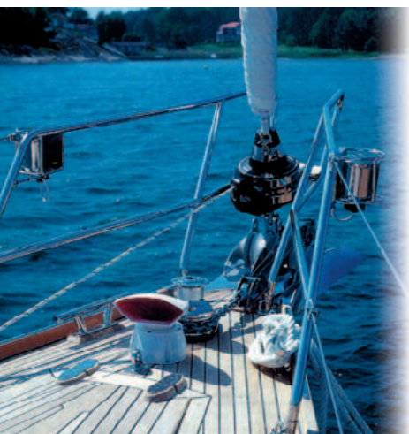
На баке любой парусной яхты вы увидите скопление дельных вещей и приспособлений. На фото виден носовой релинг, к которому прикреплены с обоих бортов ходовые огни; скрутка стакселя на штаге; якорная лебедка (шпиль); якорь; воздухозаборник; свободный рым; крышка цепного ящика; две металлических утки, одна из которых свободна, а на другой закреплена якорный конец.
