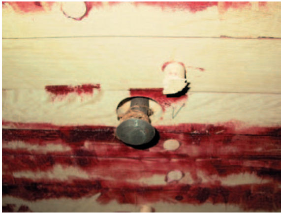
Монолит обшивки пронизан шурупами и сквозными болтами, головки которых прячутся под дубовыми пробками.
