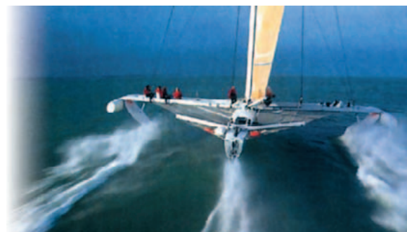
Суперсовременный тримаран на подводных крыльях в данный момент находится в неводоизмещающем состоянии корпуса.
