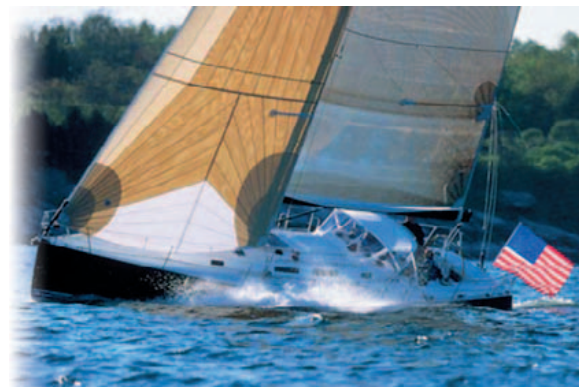
Эта водоизмещающая парусно-моторная яхта 48 футов длины. Ее фибerglassовый корпус весит меньше, чем балласт килля. Она способна успешно совершать трансокеанские переходы, так как является яхтой открытого моря.
