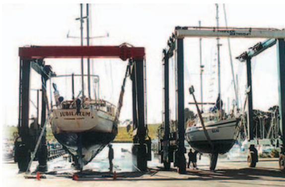
Для подъема и спуска яхт в маринах применяют специальные передвижные краны.
