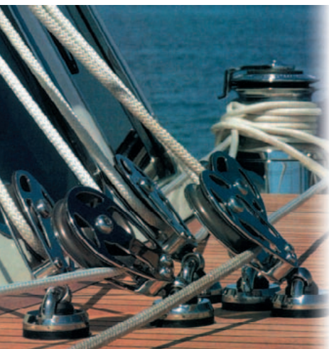
Группа вертлюжных блоков закреплена на рымах, укрепленных на палубе. Эти блоки обеспечивают правильную проводку шкотов и фалов.
