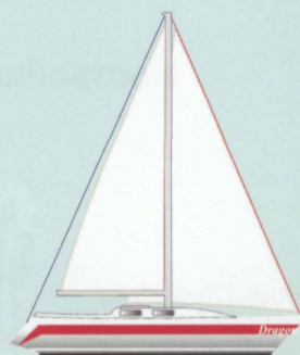
Дробное вооружение Фор-штаг закреплен на некотором расстоянии от топа мачты
