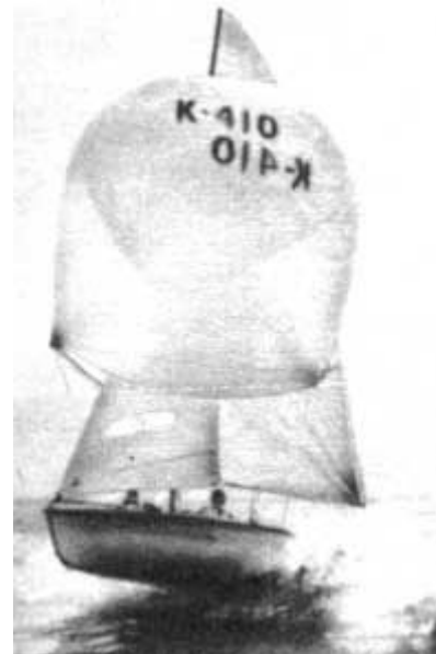
Швертбот класса "470" глиссирует в бакштаг с правильно поставленным спинакером, сохраняя постоянный дифферент на корму.
