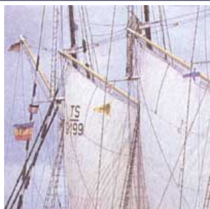
Гафельное вооружение в наши дни можно встретить на учебных парусниках и яхтах, стилизованных под старину.
