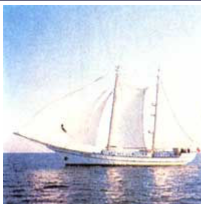
Учебная парусно-моторная шхуна с гафельным фоком и бермудским гротом. Такую оснастку называют вооружением смешанного типа.
