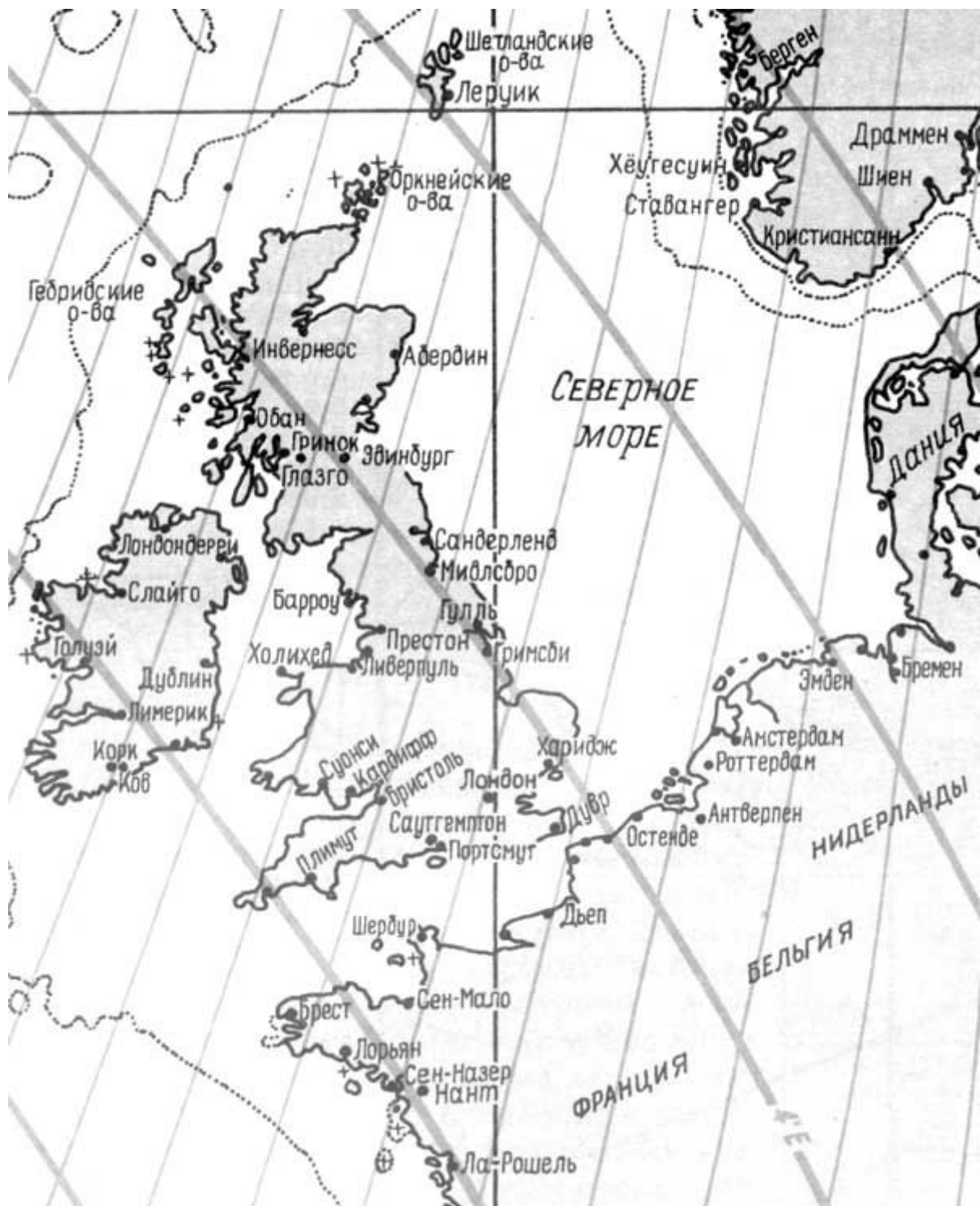
На Адмиралтейских изогонических картах (на рисунке деталь карты 5375 северной части Атлантического океана) указаны значения магнитных склонений в различных районах. Такие карты используют в дальних морских плаваниях.
